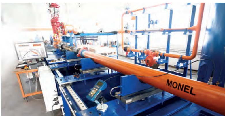
تجهیزات هیدرولیک ESP در کارخانه شرکت اوپل دینامیکز در آلمان مورد آزمایش قرار می‌گیرد
